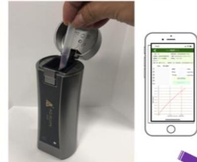
発色したパックテストチューブをそのままAQ-SCOPEにセットし、iOSアプリで精度良く簡単に測定
