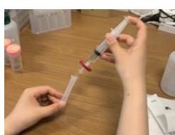
パックテストに開けた穴にプラスチック針を差し込み、パックテストの半分程度まで液を注入する。
