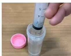
5mlシリンジを用いて、希釀用ポリ容器の液を2.5～3ml程度採取する。
