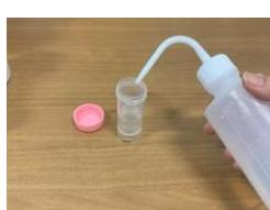
希釀用ポリ容器に希釀液を洗浄瓶から加え、25mlに調整する。
