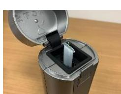
発色が安定したらAQ-Scope Soil本体のふたを開け、パックテストに開けた穴を上にして挿入し、ふたを閉じて測定する。
