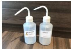
抽出液・希釀液をボトルから洗浄瓶に移します。抽出液、希釀液を使用する量だけ移してください。
