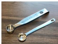
土壌種類によって、抽出に使用する土の量が変わるので、土壌種類に合ったサイズの計量スプーンを、キットの中から取り出してください。摺り切り用に1本多く用意します。
