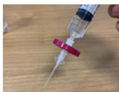
シリンジの先端にシリンジフィルターとプラスチック針を取り付ける。
